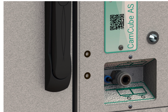
Mättuttag för tryckfallsmätning närmast serviceluckan, snabbkoppling i mässing används för läckagemätning.
